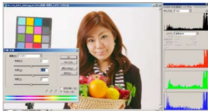
図44：色相・彩度による仕上げ調整（マスターで彩度を+10） ヒストグラム上の“櫛抜け”が改善された
