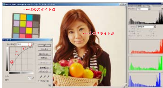
図41：コンポジットチャンネルによる調整 全体に明るい画像になったが、色カブリはそのままだ
